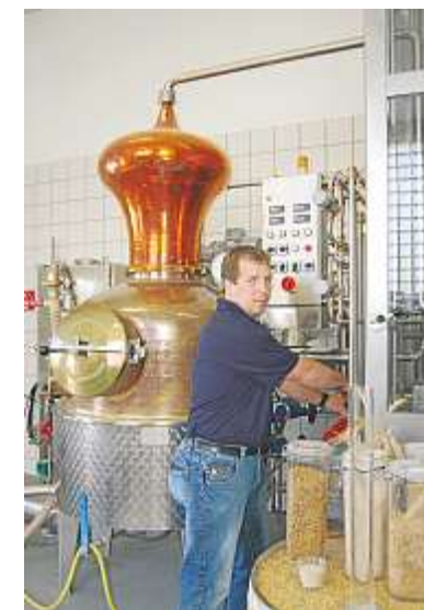
In der Brennblase wird aus Gerstenmalz Whisky destilliert.
